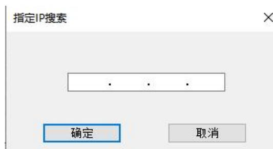
输入正确 IP 地址后，软件会搜索网络中具有这个 IP 地址的 ENB-302MI 设备。
