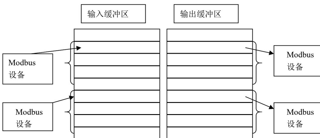
用户可以配置 **100** 条命令，每条 Modbus 命令可以读取一组连续的 Modbus 寄存器。
